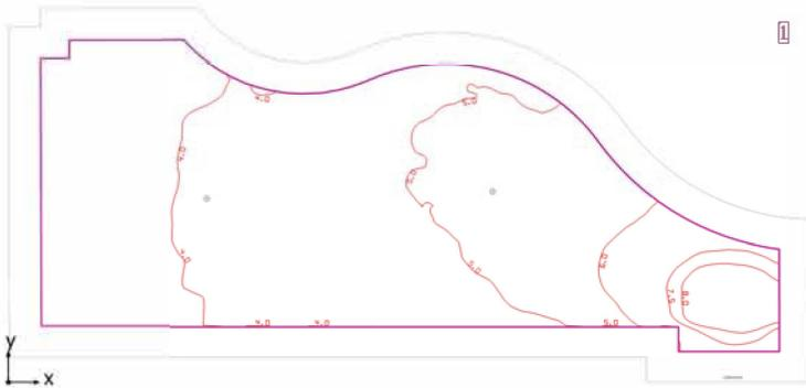
Altezza libera: 3.600 m, Coefficienti di riflessione: Soffitto 80.0%, Pareti 60.0%, Pavimento 50.0%, Fattore di diminuzione: 0.90
